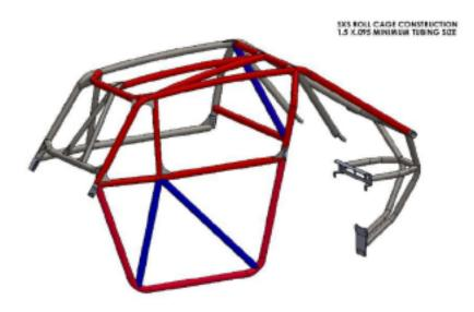
ALL TUBES SHOWN IN RED MUST BE 1.5 X .095 WALL DOOR TUBE BARS IN BLUE MUST BE 1.25 X .095 WALL MINIMUM
